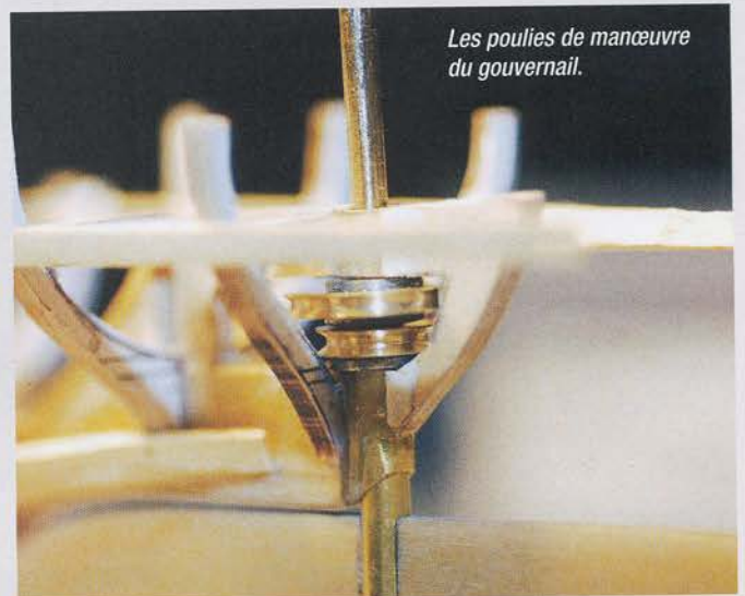
Creusement de la poupe pour dégager la commande du gouvernail.
